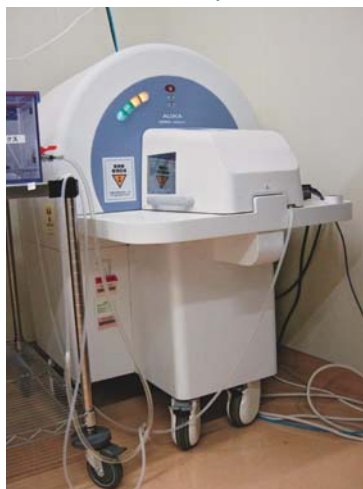
小動物用X線 CT 装置 Latheta LCT-200 (日立アロカメディカル)
