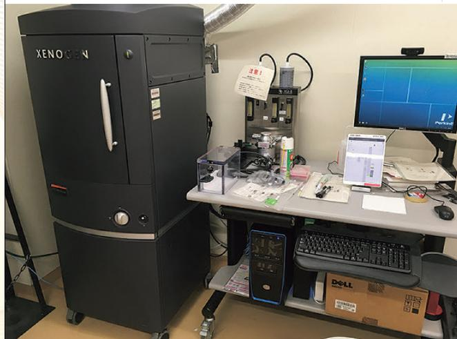
IVIS imaging System IVIS Spectrum) (左下図)：マウス、ラットを生かしたまま化学発光または蛍光から得られる微量光を画像解析を行う。測定用暗箱は、極微量の宇宙線などの外光線も遮断できる構造で、超高感度冷却 CCD カメラを用いて化学発光・蛍光を検出する。
